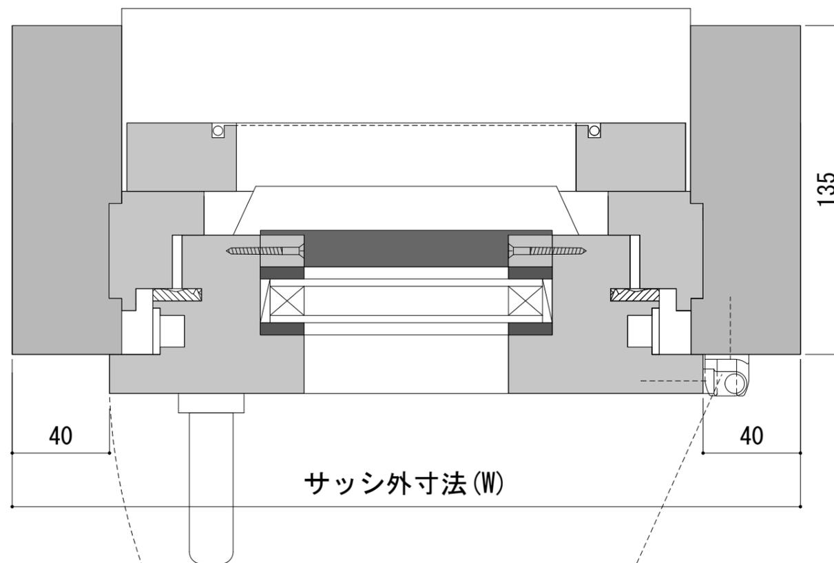
木製サッシドレーキップ窓 断面詳細図
