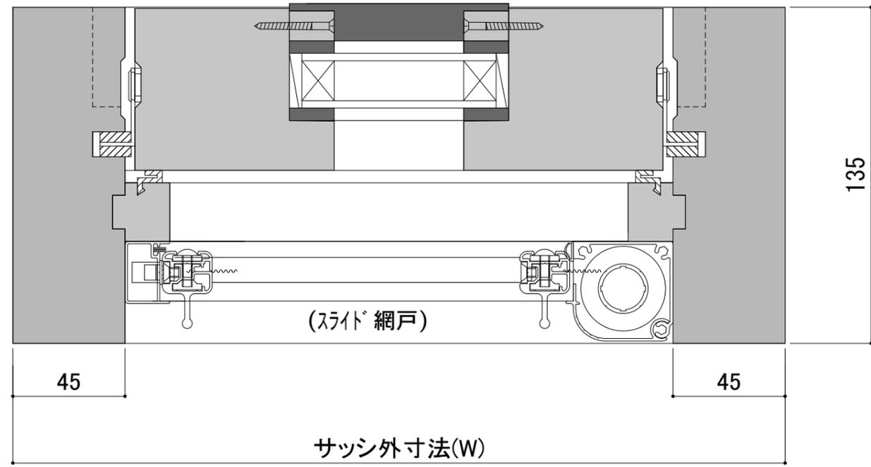
木製サッシ 回転窓 断面詳細図
