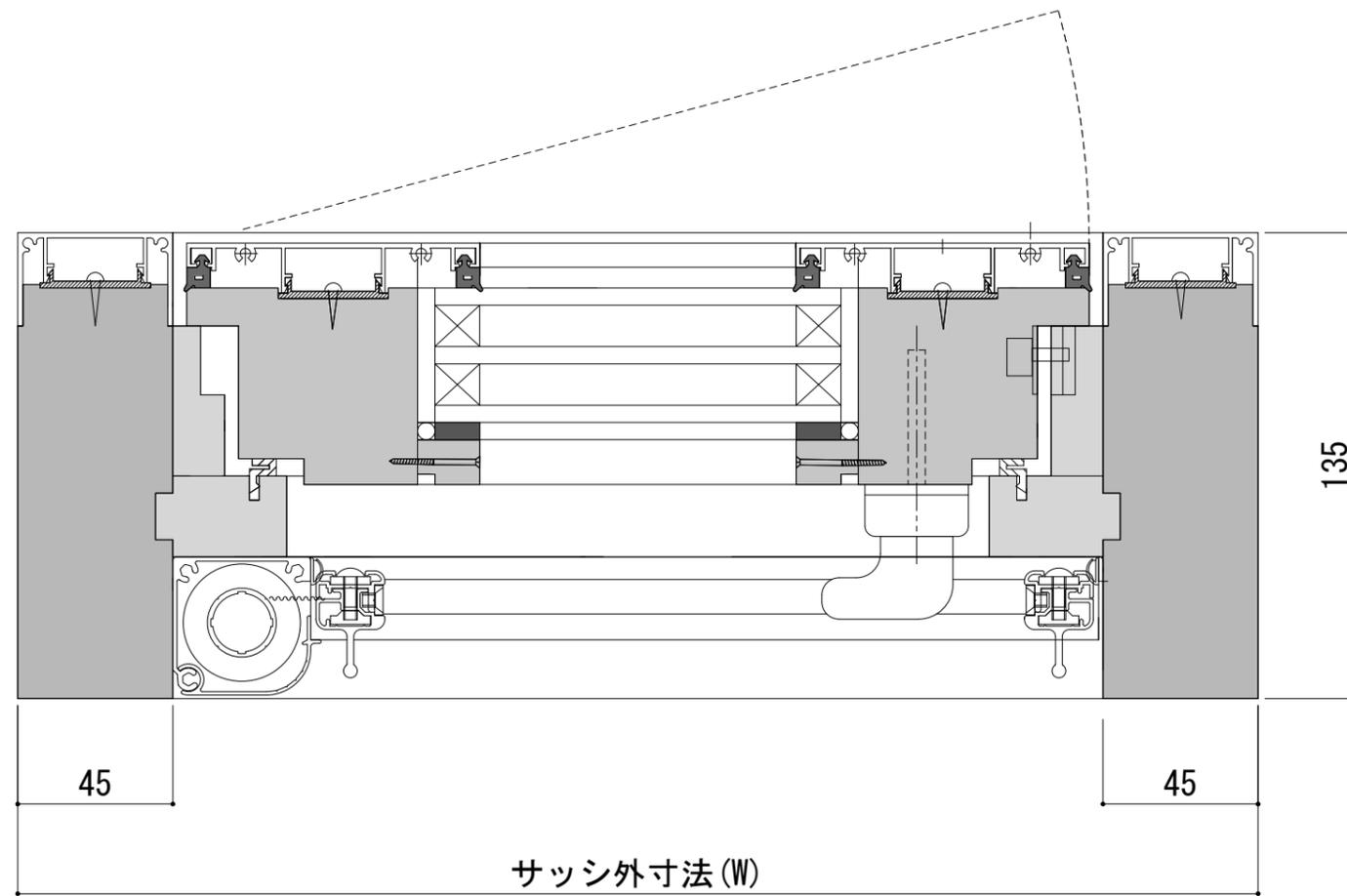
木製+アルミクラッド サッシ 外開き窓 断面詳細図
